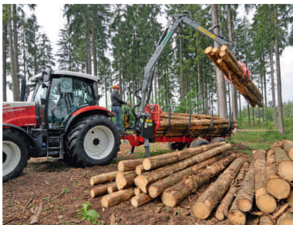
Landwirtschaftlicher Schlepper mit Rückewagen zum Transport von Kurzholz und Abschnitten
